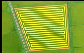
▲事前に圃場を測りタブレットに登録するだけで、飛行経路を自動生成
